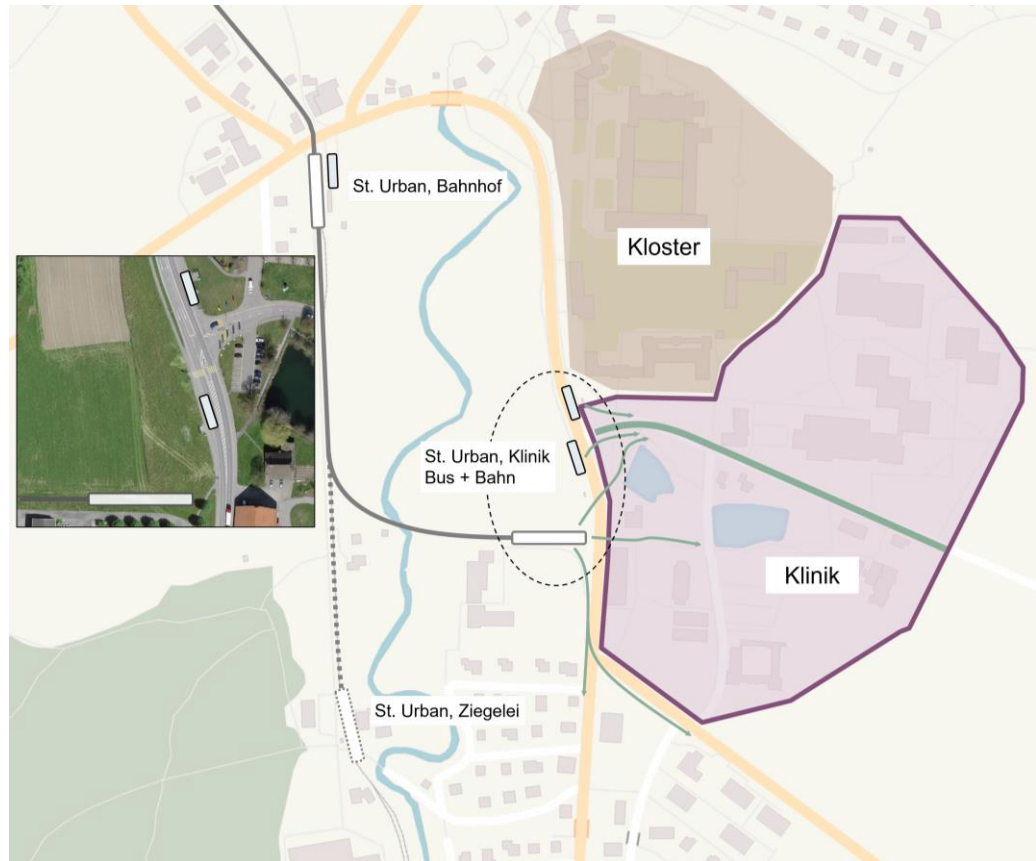
Abbildung 5: Situation Haltestellen St. Urban. Die angestrebte neue Bahnhofshaltestelle wird hinsichtlich der Erschliessungswirkung der bestehenden Bushaltestelle gleichgesetzt.
