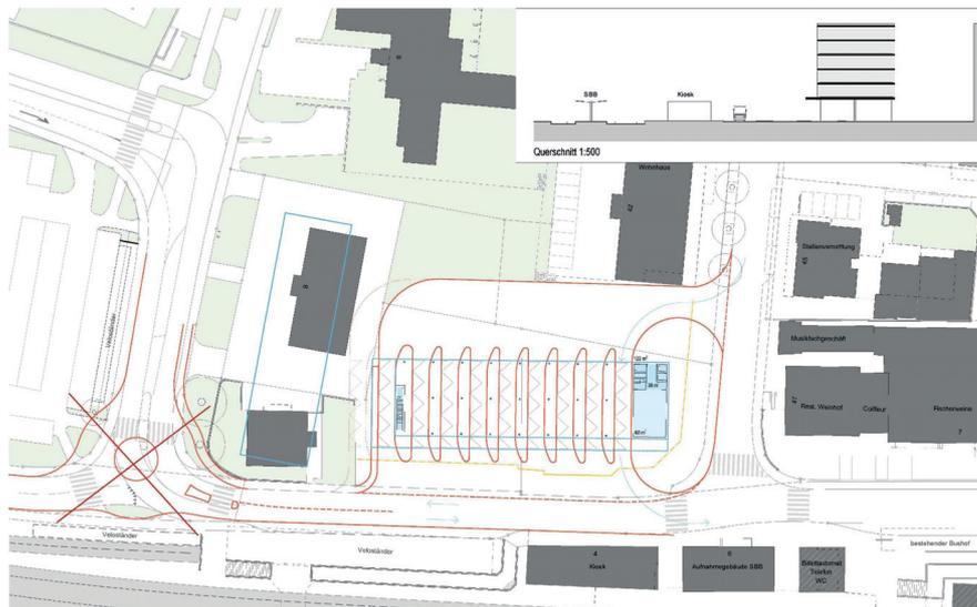
Abb. 26 Buskanten in Parallelanordnung am Standort 1 (Var 1.P). Beispiel mit 90° Senkrechtnanordnung. Der Kreisverkehr ist nur bei Schräganordnungen notwendig. Quelle: metron
