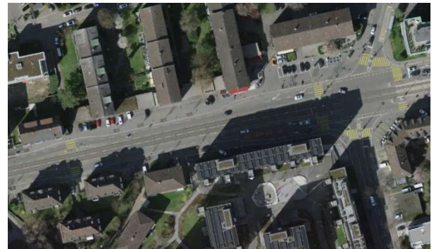
Abbildung 14: Referenz: Bus-/Tramtrasse in Mittellage, Birmensorferstrasse in Zürich (Quelle: swisstopo)
