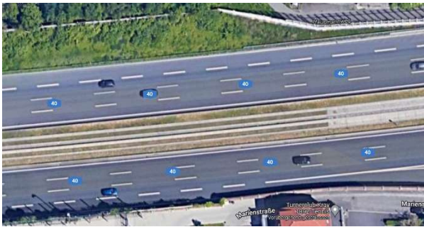
Abbildung 22: Essener Spurbus in A40, begrünter Mittelstreifen zwischen Rädern (Quelle: Google Maps)
