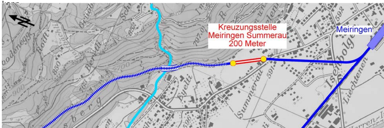
Abbildung 9-20: Objekt 09: Kreuzungsstelle Summerau, in der Ebene unmittelbar nach dem Ende der Zahnstangenstrecke Brünig Passhöhe – Meiringen.
