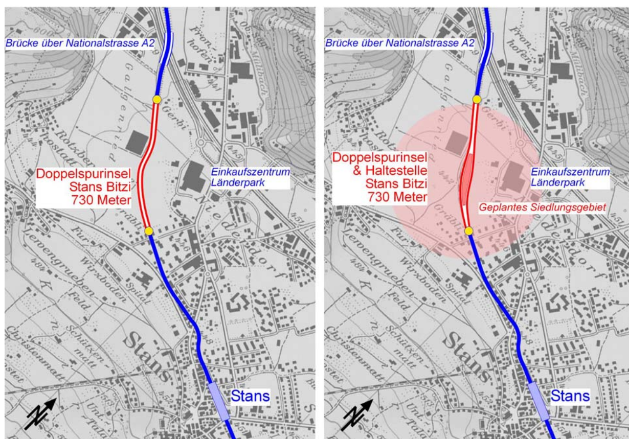
Abbildung 9-07: Objekt 03: Doppelspur im Raum Stans Bitzi. Links ohne, rechts mit einer neuen Haltestelle Stans Bitzi.
