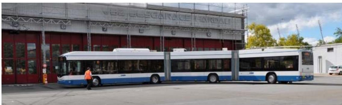
Abbildung 12: Neuer Doppelgelenktrolleybus der VBZ mit Traktionsbatterie (Quelle: [www.vbz.ch](http://www.vbz.ch))
