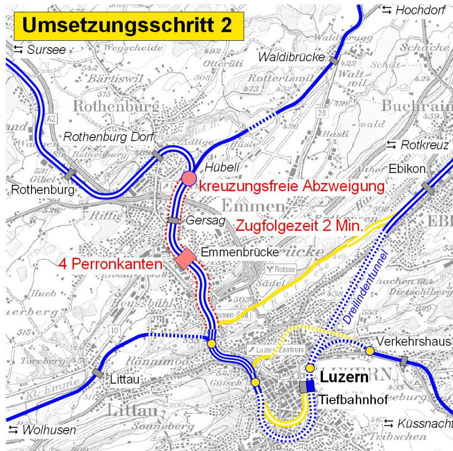
Abbildung 11-04: Schienennetz im Raum Luzern nach der Umsetzung des zweiten Umsetzungsschrittes: Verkürzung der Zugfolgezeiten, vier Perronkanten in Emmenbrücke sowie kreuzungsfreie Abzweigung Hübli.
