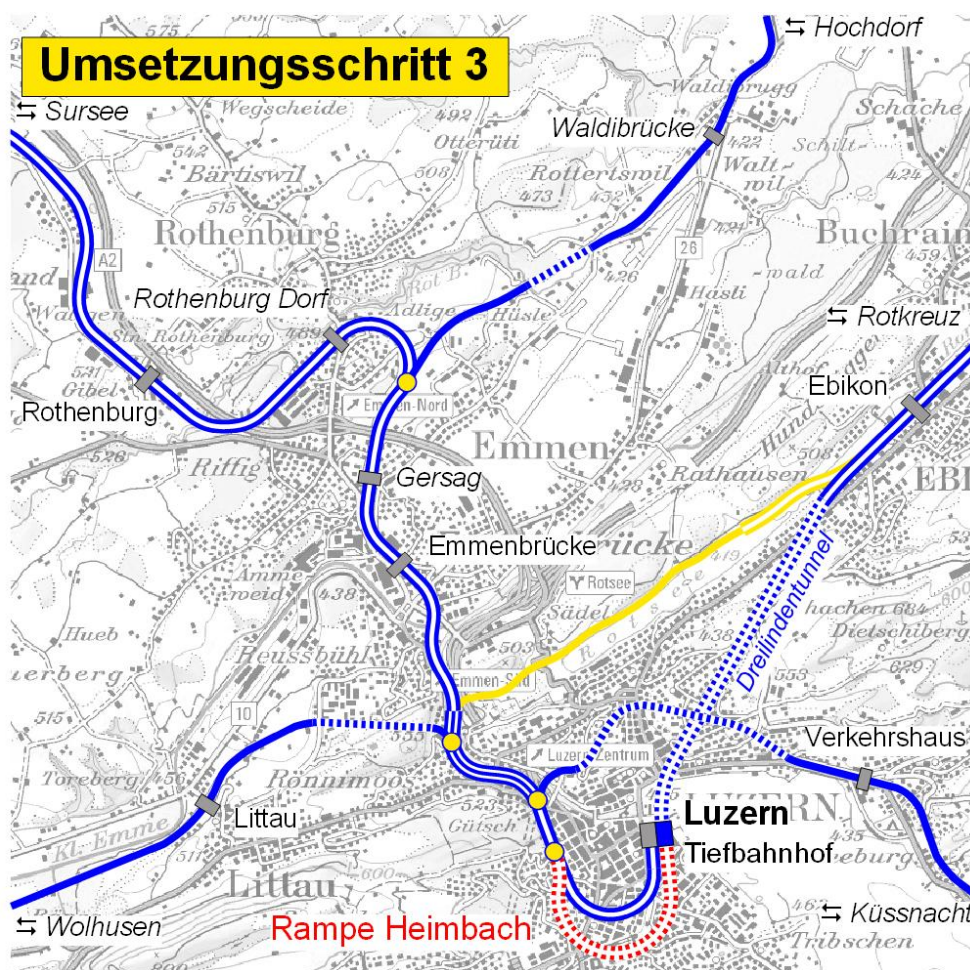
Abbildung 11-07: Schienennetz im Raum Luzern nach der Umsetzung des dritten Umsetzungsschrittes. Mit einer Rampe zwischen dem Tiefbahnhof und der Stammstrecke entsteht ein Durchgangsbahnhof.
