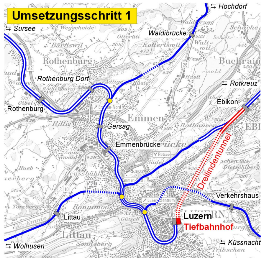
Abbildung 11-01: Schienennetz im Raum Luzern nach der Umsetzung des ersten Umsetzungsschrittes mit dem Tiefbahnhof als Kopfbahnhof und dem Dreilindentunnel.
