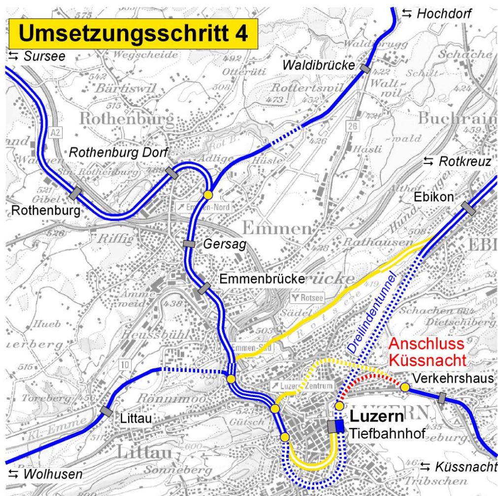
Abbildung 11-10: Schienennetz im Raum Luzern nach der Umsetzung des vierten Umsetzungsschrittes. Mit dem Anschluss der Küssnachterlinie an den Tiefbahnhof verkehren alle Züge als Durchmesserlinien.
