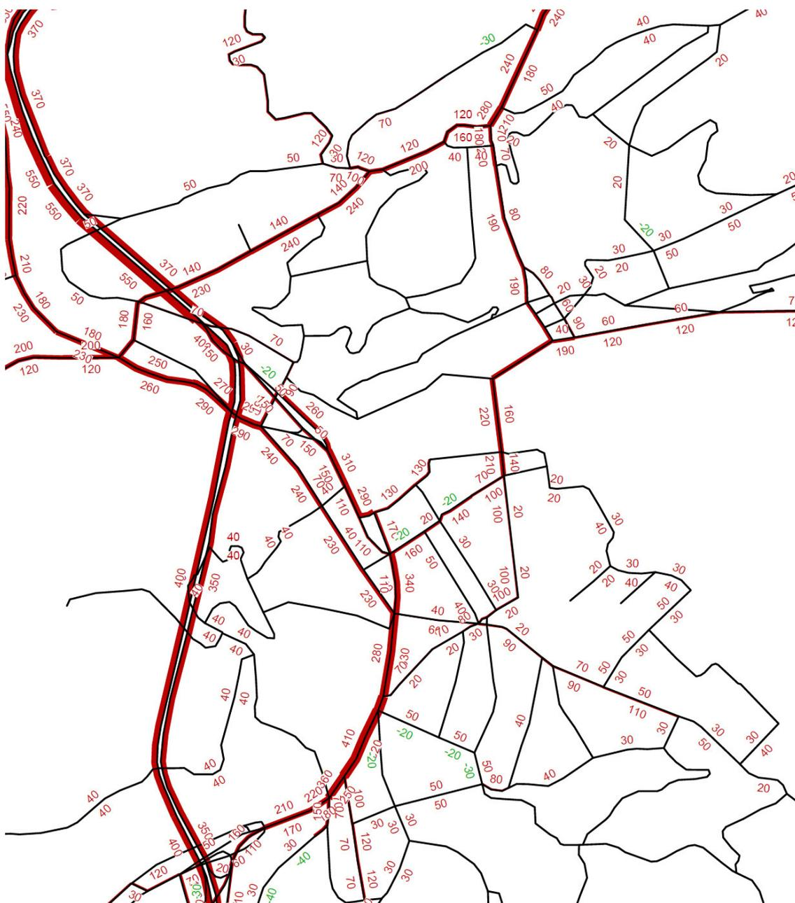
**Abbildung 6: Verkehrsbelastungen Abendspitzenstunde (Fz/h), Differenz Prognose 2030 – Ist-Zustand (rot = Mehrbelastung 2030)**
